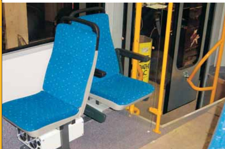
Sedačka pro průvodčího je v modernizované tramvaji umístěna na stejném místě před posledními dveřmi, jako je tomu v původní tramvaji T3SU.
