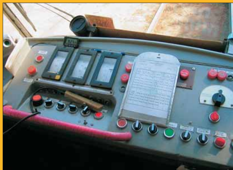
Srovnání nového a původního pultu řidiče nepotřebuje žádný komentář. Ale snad přece – u pultu T3SU stojí za povšimnutí zakrytí chybějících nefunkčních kontrolků plastovými zátkami od piva...
