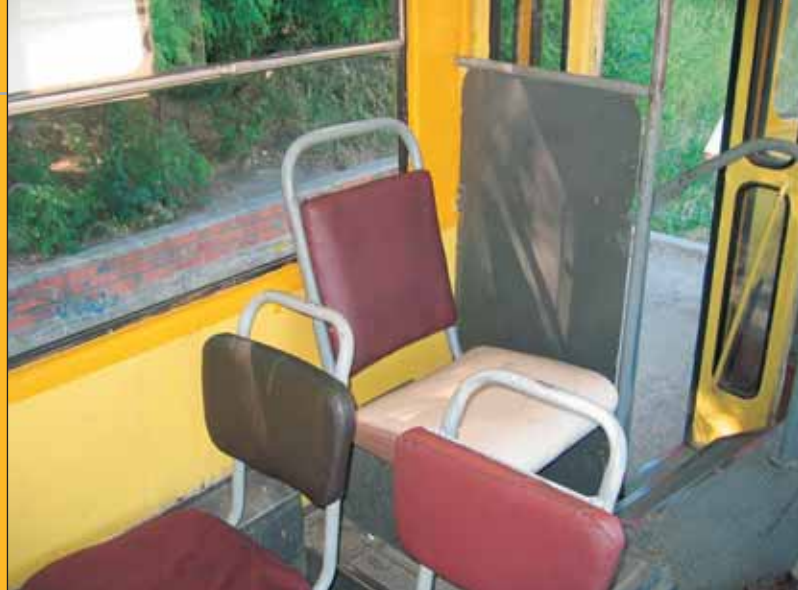
Sedačka pro průvodčího je v modernizované tramvaji umístěna na stejném místě před posledními dveřmi, jako je tomu v původní tramvaji T3SU.
