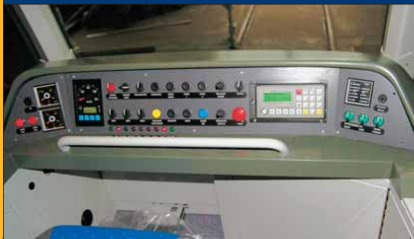
Srovnání nového a původního pultu řidiče nepotřebuje žádný komentář. Ale snad přece – u pultu T3SU stojí za povšimnutí zakrytí chybějících nefunkčních kontrolků plastovými zátkami od piva...
